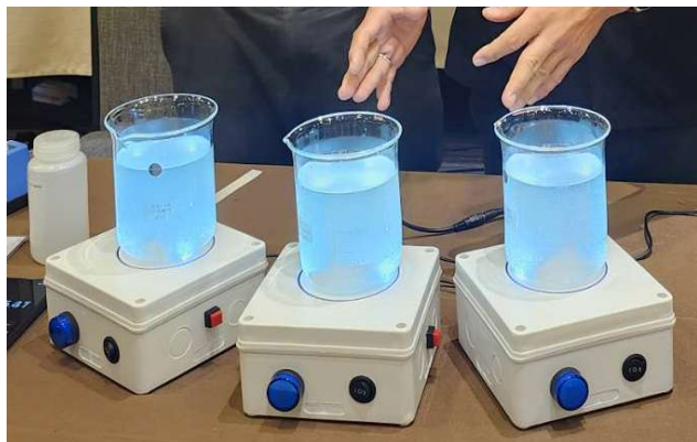
อุปกรณ์ช่วยตกตะกอนชนิดกวนด้วยแม่เหล็กแบบสองความเร็ว สำหรับประเมินปริมาณสารสร้างตะกอนภาคสนาม (Mobil Jar Tester) พัฒนาโดยสวทช
