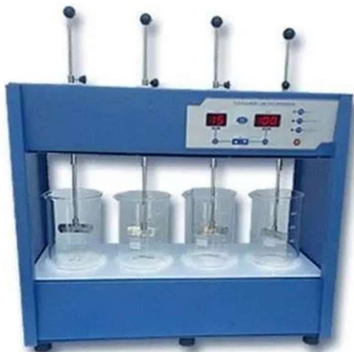
ตัวอย่างอุปกรณ์จาร์ เทส (Jar Test) สำหรับประเมินปริมาณสารสร้างตะกอน
